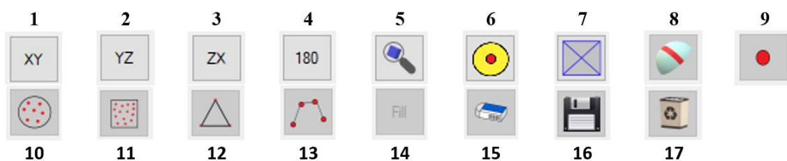
Рисунок 5.5 – изображение кнопок боковой панели 4 (Рисунок 3.1). 1 – вид в проекции на плоскость XY; 2 – вид в проекции на плоскость YZ; 3 – вид в проекции на плоскость ZX; 4 – поворот объекта на 180°; 5 – центрировать объект; 6 – показать/скрыть точку начала отсчета; 7 – показать/скрыть плоскость начала отсчета; 8 – выбрать срез на облаке точек; 9 – выбрать одну точку; 10 – выбор точек внутри круга; 11 – выбор точек внутри прямоугольника; 12 – выбрать вершины треугольника; 13 – выбрать точки на линии; 14 – заполнить область дополнительными точками; 15 – очистить выбор точек; 16 – сохранить изменения в облаке точек; 17 – отменить изменения в облаке точек
